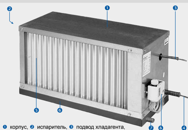
Рис. 1 - конструкция прямого охладителя
